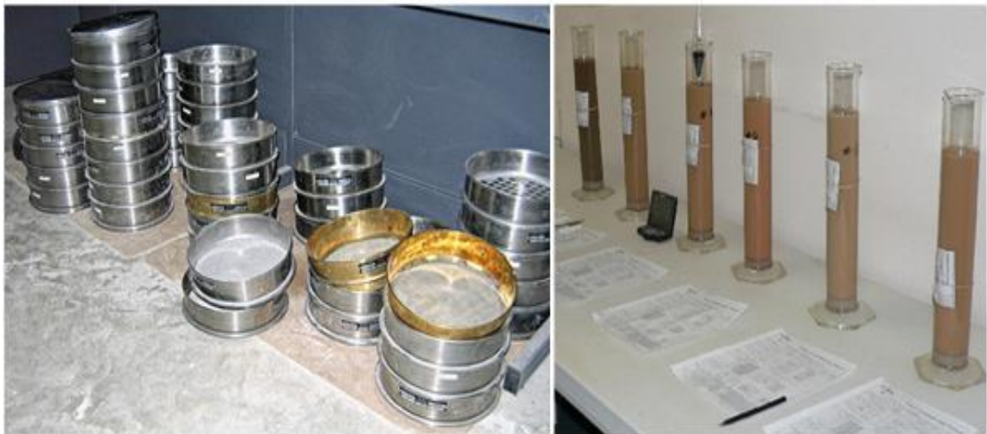
Hình 7: Dụng cụ thí nghiệm thành phần hạt/ Figure 7: Apparatus for partical size distribution test
