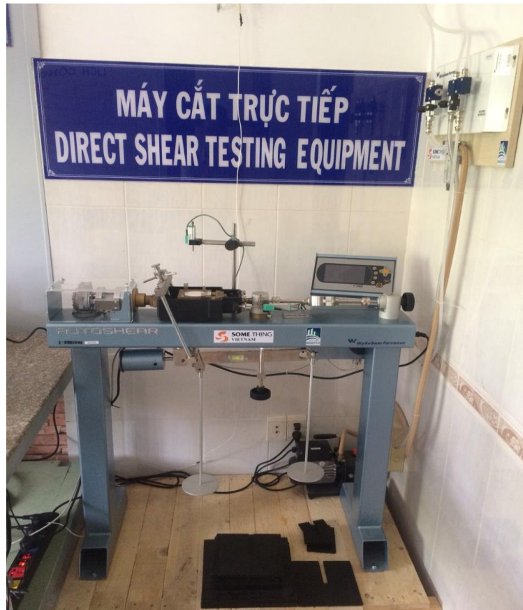
Hình 12: Dụng cụ thí nghiệm cắt phẳng/ Figure 12: Apparatus for Direct shear test
