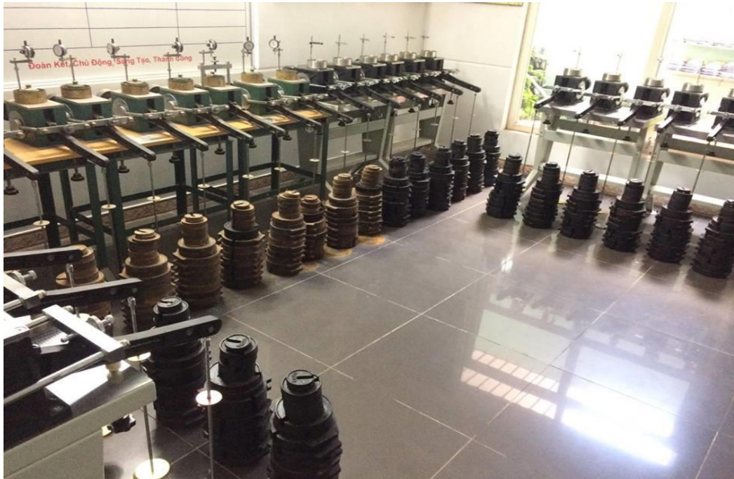
Hình 13: Dụng cụ thí nghiệm nén lún/ Figure 13: Apparatus for compression test
