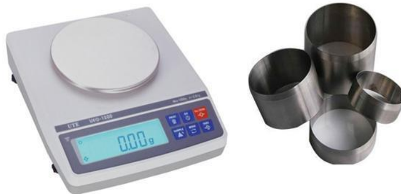
Hình 9: Dụng cụ thí nghiệm dung trọng/ Figure 9: Apparatus for unit weight test
