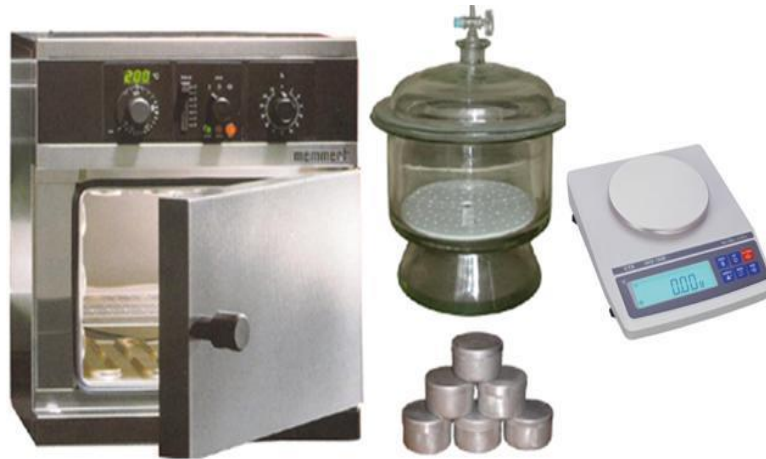
Hình 8: Dụng cụ thí nghiệm độ ẩm/ Figure 8: Apparatus for water content test
