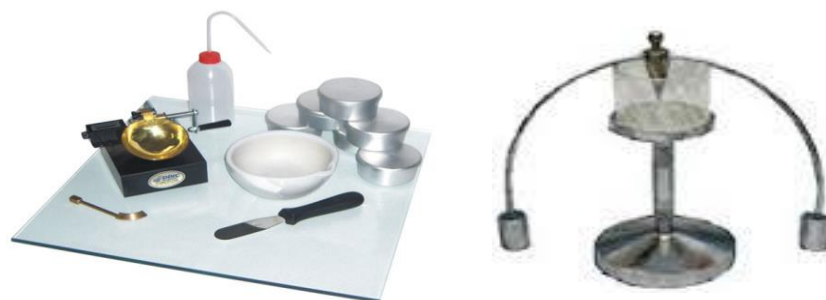
Hình 11: Dụng cụ thí nghiệm giới hạn Atterberg/ Figure 11: Apparatus for Atterberg limit test
