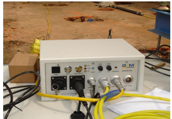
Hình 4: Mũi côn điện kiểu AC10CFIIP và thiết bị thu nhận dữ liệu loại GME 500 IP65
