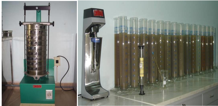
(Hình 6: Thí nghiệm thành phần hạt)
