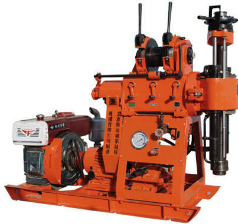
Hình 3: Máy khoan XY - 1A-4 do hãng Stonewell sản xuất
